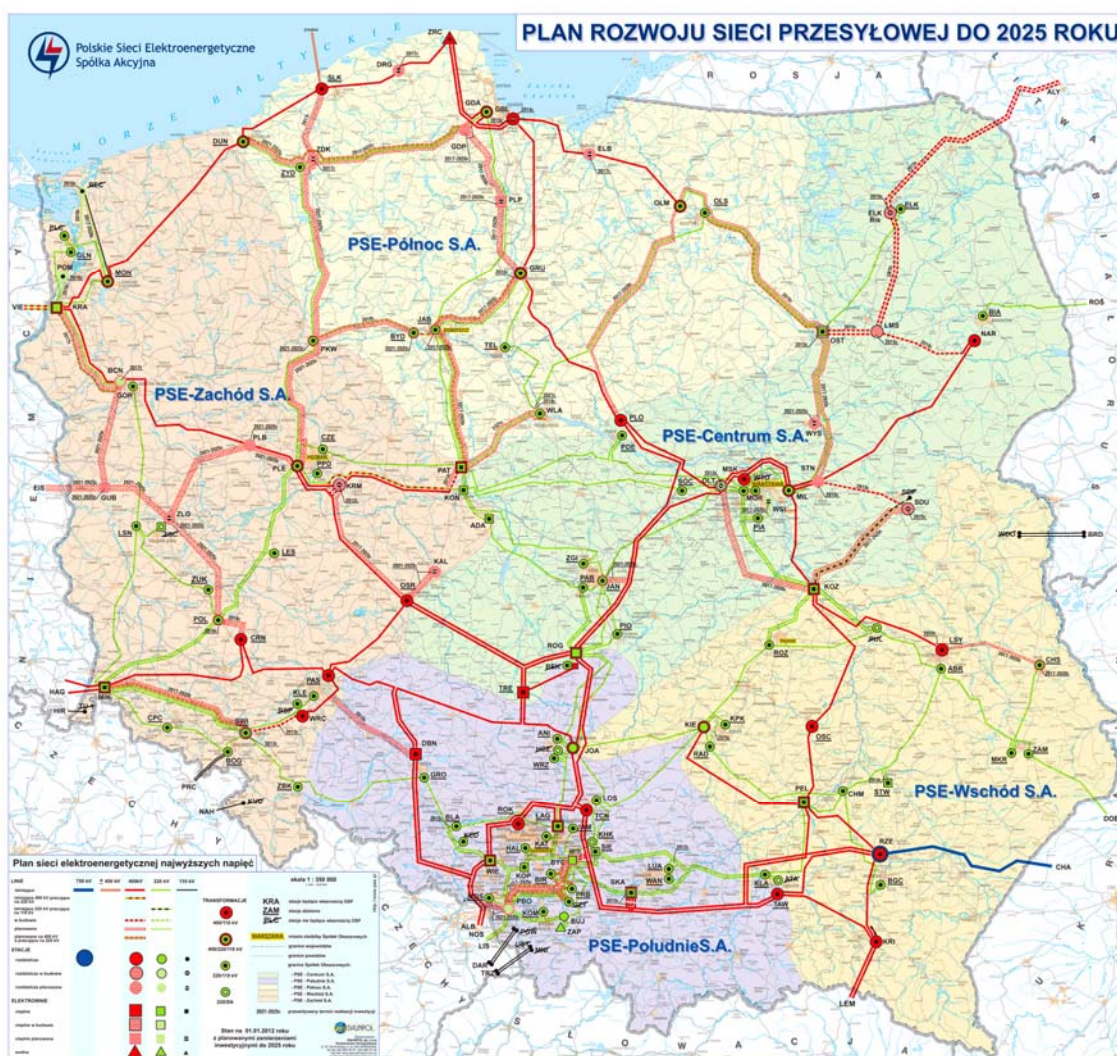
Rys. 89. Plan sieci elektroenergetycznej najwyższych napięć źródło: PSE
